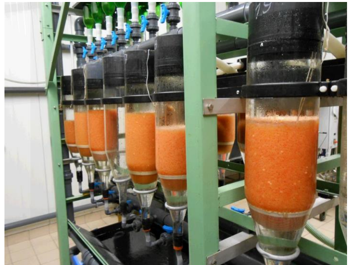
(Erbrütung von Meerforellen in Zugergläsern bei der LFA in Born / Foto LGMV)
